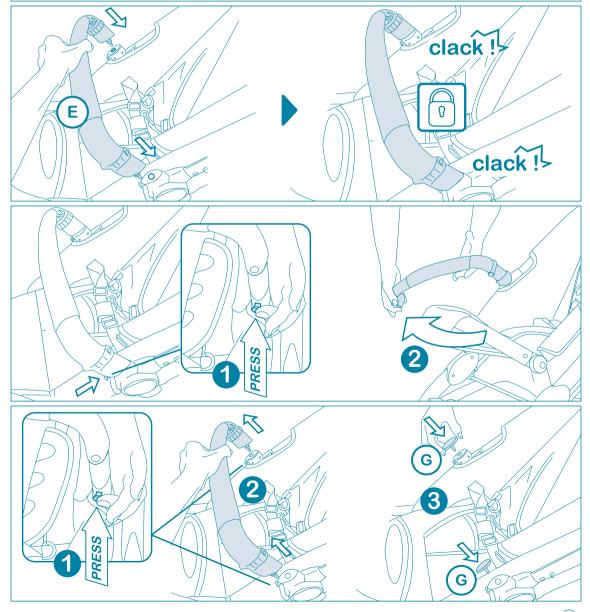
REGOLAZIONE INCLINAZIONE DELLA SEDUTA • ADJUSTING THE SEATING ANGLE • VERSTELLUNG DER RÜCKENLEHNE • INCLINAISON • INCLINACION • INCLINAÇÃO • PRILAGODITEV SEDEŽNEGA DELA • REGULACJA KĄTA SIEDZENIA • AZ ÜLÉS DŐLÉSSZÖGÉNEK BEÁLLÍTÁSA • PODEŠAVANJE KUTA SJEDENJA • PEΓΥJΠΡΟΒΚΑ ΗΑΚΠΟΗΑ CИДЕНИЯ • INSTÄLLNING AV SITTLÄGE • DE SCHUINE STAND VAN DE ZITTING AFSTELLEN • PΎΘΜΙΣΗ ΤΗΣ ΚΛΊΣΗΣ ΤΟΥ ΚΑΘΊΣΜΑΤΟΣ • AJUSTAREA SEZUTULUI
