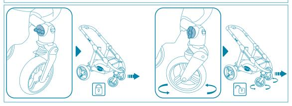
RUOTE:UTILIZZO DEL FRENO • WHEELS: HOW TO USE THE BRAKE • RÄDER: VERWENDUNG DER BREMSE • ROUES: UTILISATION DU FREIN • RUEDAS: UTILIZACIÓN DEL FRENO • RODAS: UTILIZAÇÃO DO TRAVÃO • KOLESA: UPORABA ZAVOR • KOŁA: JAK UŻYWAĆ HAMULCA • KEREKEK: A FÉK HASZNÁLATA • KOTAČI: KAKO UPOTREBLJAVATI KOČNICU • KOJECA: ИСПОЛЬЗОВАНИЕ ТОРМОЗА • HJUL: HUR MAN ANVÄNDER BROMSEN • WIELEN: GEBRUIK VAN DE REM • POΔΕΣ: ΧΡΉΣΗ ΦΡΈΝΟΥ • ROTI: CUM SA FOLOSITI FRANA
