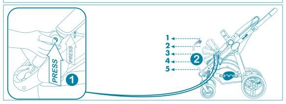
RIMOZIONE DELLE RUOTE • REMOVING THE WHEELS • ABNEHMEN DER RÄDER • POUR RE-TIRER LES ROUES • REMOVER LAS RUEDAS • REMOVER AS RODAS • SNEMANJE KOLES • USUWANIE KÓŁ ● A KEREKEK ELTÁVOLÍTÁSA ● ODSPAJANJE KOTAČA ● ДЕМОНТАЖ КОЛЕС • HUR MAN TAR BORT HJULEN • AFNEMEN VAN DE WIELEN • ΑΦΑΙΡΕΣΉ ΤΩΝ ΤΡΟΧΩΝ • **FIXARFA ROTIL OR**
