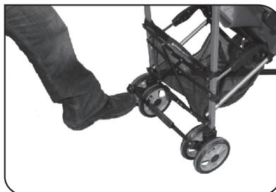
Per disattivare il freno di stazionamento, sollevare il pedale.
