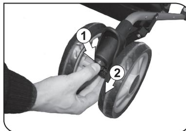
**Per rimuovere le ruote anteriori:** premere il dispositivo di bloccaggio, nella parte inferiore della ruota e mantenendolo premuto, rimuovere la ruota dal mozzo.
