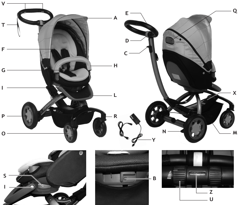
Poussette avec roues arrière équipées de pneus avec chambre à air et avec pompe à main en dotation.
