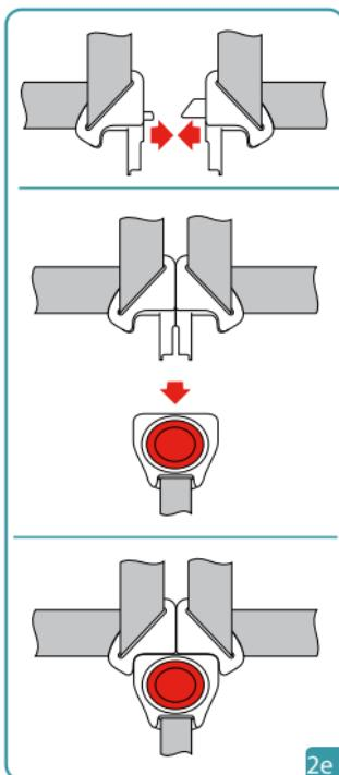
Una as duas extremidades da fita, inserindo-as na fita central. (2e)
