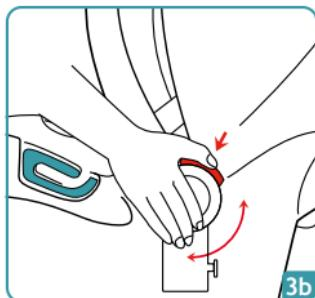
Para regular la manilla en las diferentes posiciones pulsar a la vez los botones de ambos lados y girar la manilla. La manilla se bloqueará en su posición. (soltar a continuación los botones y seguir girando la misma hasta que se bloquee en la nueva posición.)
