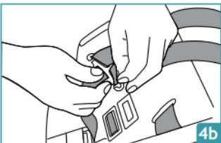
Per regolare la posizione delle bretelle, è necessario sganciare le cinghie dalla staffa tendicintura, posizionata sul retro dello schienale.
