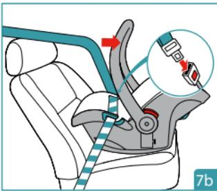
Passare la cintura di sicurezza orizzontale (addominale) della vettura in entrambi i passaggi cintura e allacciare la fibbia.
