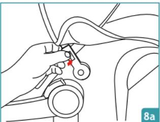
Haal het frame van de kap los door aan het lipje aan één van de zijden te trekken .
