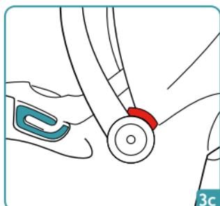
Pour régler la anse dans les différentes positions, appuyer simultanément les boutons des deux côtés et tourner la anse. La anse se bloquera en position. (relâcher ensuite les boutons et continuer la rotation, jusqu'au blocage dans la nouvelle position.)
