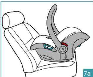
Plaats de veiligheidsinrichting voor kinderen op de passagiersstoel tegen de rijrichting in gedraaid. Controleer of de draagbeugel in de juiste stand is geplaatst. Uw kind bevindt zich dus tegen de rijrichting van het voertuig in gedraaid.
