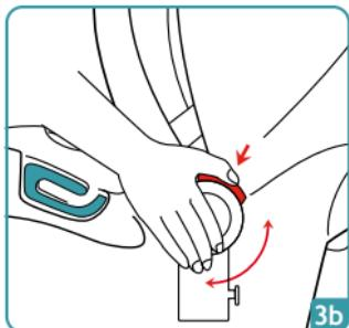
Druk tegelijkertijd de drukknoppen aan beide zijden in en verplaats de draagbeugel tot de gewenste stand is bereikt. De draagbeugel wordt in de gekozen stand geblokkeerd. (laat de drukknoppen vervolgens los en verplaats de draagbeugel tot deze in de nieuwe stand wordt geblokkeerd.)
