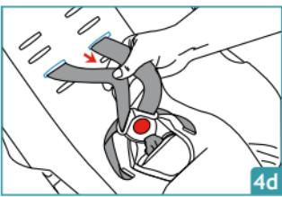
Verwijder de gordels door ze door de bekleding en de behuizing te halen.
