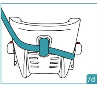
Stel de hoogte af op de laagst mogelijke stand als de veiligheidsgordel van het voertuig te kort is. Probeer het autozitje op een andere autostoel vast te zetten als de gordel nog altijd te kort is. .
