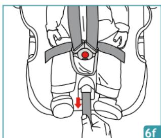
Tirare la cinghia di regolazione dell'imbracatura in modo da tensionarla correttamente contro il corpo del bambino. Una corretta tensionatura è tale che lo spazio tra l'imbracatura e il bambino non deve essere superiore allo spessore di un dito.
