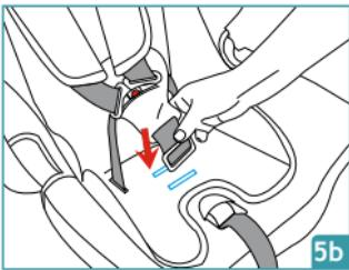
De kruisgordel kan afhankelijk van de grootte van uw kind in twee standen worden geplaatst. Plaats de riem in de buitenste sleuf als uw kind meer dan 7 kg weegt. Dit is doorgaans het geval als de schoudergordels in de centrale sleuven zijn aangebracht.
