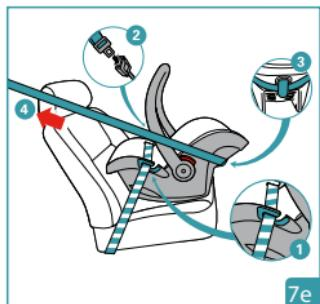
Coloque o dispositivo de retenção na posição correta, a fim de garantir a máxima segurança da criança. É possível usar uma toalha firmemente enrolada e colocá-la sob a borda dianteira da cadeira, de modo a obter um recline adequado.
