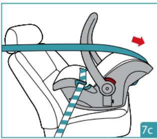
Passare la cintura di sicurezza diagonale (pettorale) della vettura, intorno allo schienale del seggiolino, passando attraverso il passante per la cintura diagonale.
