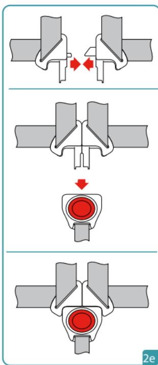
Соедините две пряжки замка и вставьте их в центральный замок. (2e)
