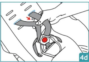
Saque/Extraiga los dos cinturones a través del revestimiento y del bastidor.
