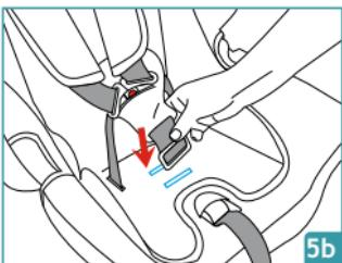
Der Schrittgurt ist in zwei Positionen je nach Größe des Kindes verstellbar. Der Riemen darf nur in die äußerste Öse geschoben werden, wenn das Kind mehr als 7 kg wiegt. Ansonsten werden für die Hosenträger in der Regel die Ösen in der Mitte verwendet.
