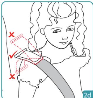
Regolare la posizione delle bretelle in base all'altezza del bambino. Le bretelle devono essere regolate nelle asole in prossimità alle spalle del bambino. Non utilizzare questo dispositivo di ritenuta nel caso le spalle del bambino siano sopra le asole nella posizione più alta nello schienale della scocca o se il bambino pesa più di 13 kg.
