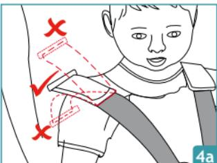
Regolare la posizione delle bretelle in modo che siano allo stesso livello o leggermente al di sotto delle spalle del bambino.
