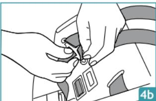
Es necesario desenganchar las correas de la abrazadera tensa-cinturón que se encuentra en la parte posterior del respaldo, para regular los tirantes.
