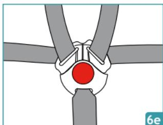
Inserire il connettore nella fibbia centrale fino a udire un click. Assicurarsi che le bretelle non siano attorcigliate. Regolare le protezioni pettorali al centro delle spalle del bambino.
