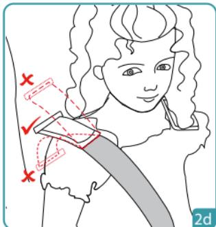
Stel de positie van de schoudergordels af aan de hand van de lengte van uw kind. Haal de schoudergordels door de sleuven ter hoogte van de schouders van uw kind. Gebruik deze veiligheidsinrichting niet als de schouders van uw kinderen boven de bovenste sleuven in de behuizing uitsteken of als uw kind meer dan 13 kg weegt.
