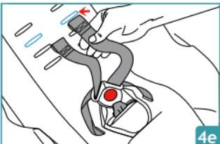
Breng de gordels aan in de gewenste sleuven. Controleer of ze niet zijn gedraaid en op dezelfde hoogte zijn geplaatst. Plaats de gordels weer in de spanner op de rugleuning (4b omgekeerd). Controleer of de schoudergordels goed aan de metalen beugel zijn bevestigd door eraan te trekken. Onthoud dat de schoudergordels op dezelfde hoogte of net onder de schouders van uw kind moeten zijn geplaatst (4a).
