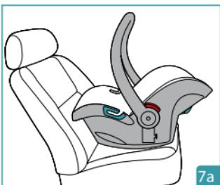
Posizionare il dispositivo di ritenuta per bambini sul sedile passeggero, con orientamento in senso opposto di marcia e assicurarsi che la maniglia sia regolata in posizione corretta. Il bambino sarà orientato in senso contrario di marcia.
