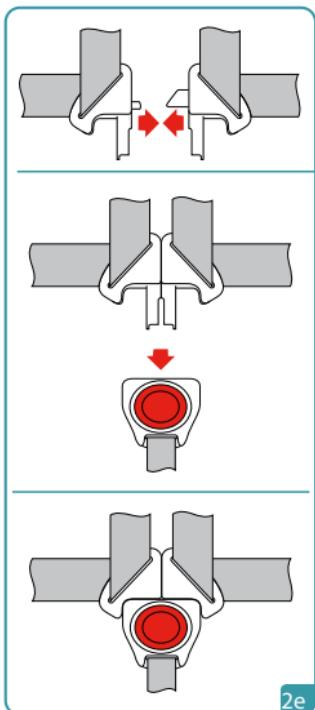
Unir les deux connecteurs de la boucle, en les introduisant dans la boucle centrale. (2e).
