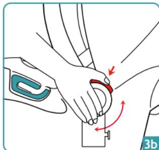
Для регулировки ручки одновременно нажмите кнопки, расположенные по обеим сторонам ручки и поверните ручку. Затем отпустите кнопки и продолжайте поворачивать ручку, пока она не заблокируется в новом положении.
